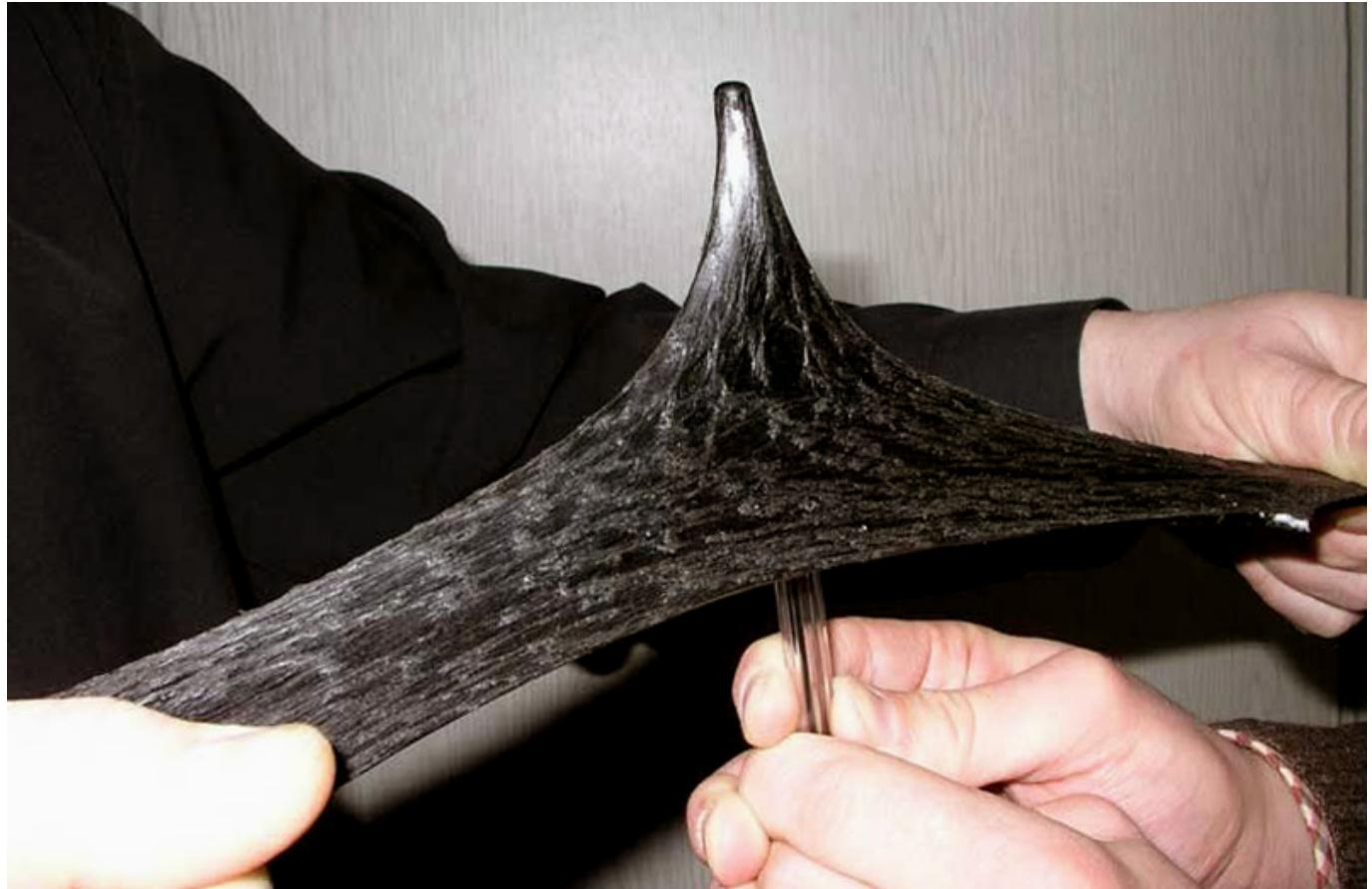
Битум асосида тайёрланган бу каби мастикалар цемент-бетон қопламали автомобиль йўллари, шунингдек, аэродромлардаги чуқурлар ва чокларни герметизация қилиш ва мустаҳкамлаш учун қўлланилади.
