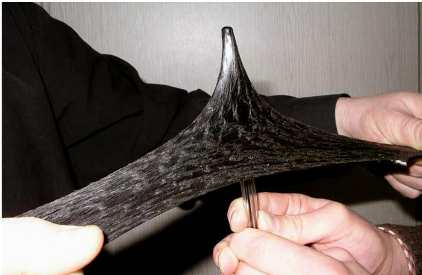
Битумная мастика, приготовленная на основе битума, предназначена для герметизации продольных и поперечных деформационных швов и сквозных трещин на цементобетонных покрытиях автомобильных дорог, а также аэродромов.
