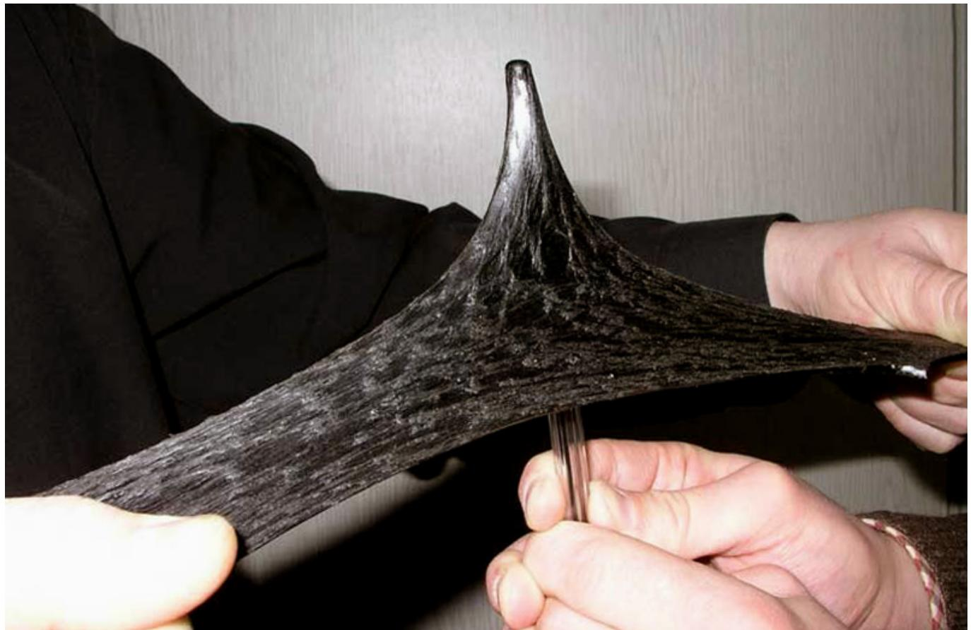
Bitum asosida tayyorlangan bu kabi mastikalar tsement-beton qoplamali avtomobil yo'llari, shuningdek, aerodromlardagi chuqurlar va choklarni germetizatsiya qilish va mustahkamlash uchun qo'llaniladi.
